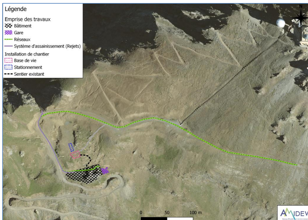
Carte n° 2 : Localisation des emprises travaux
